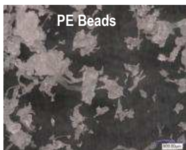
SEM of PE beads and ImerCare™400P-Scrub
